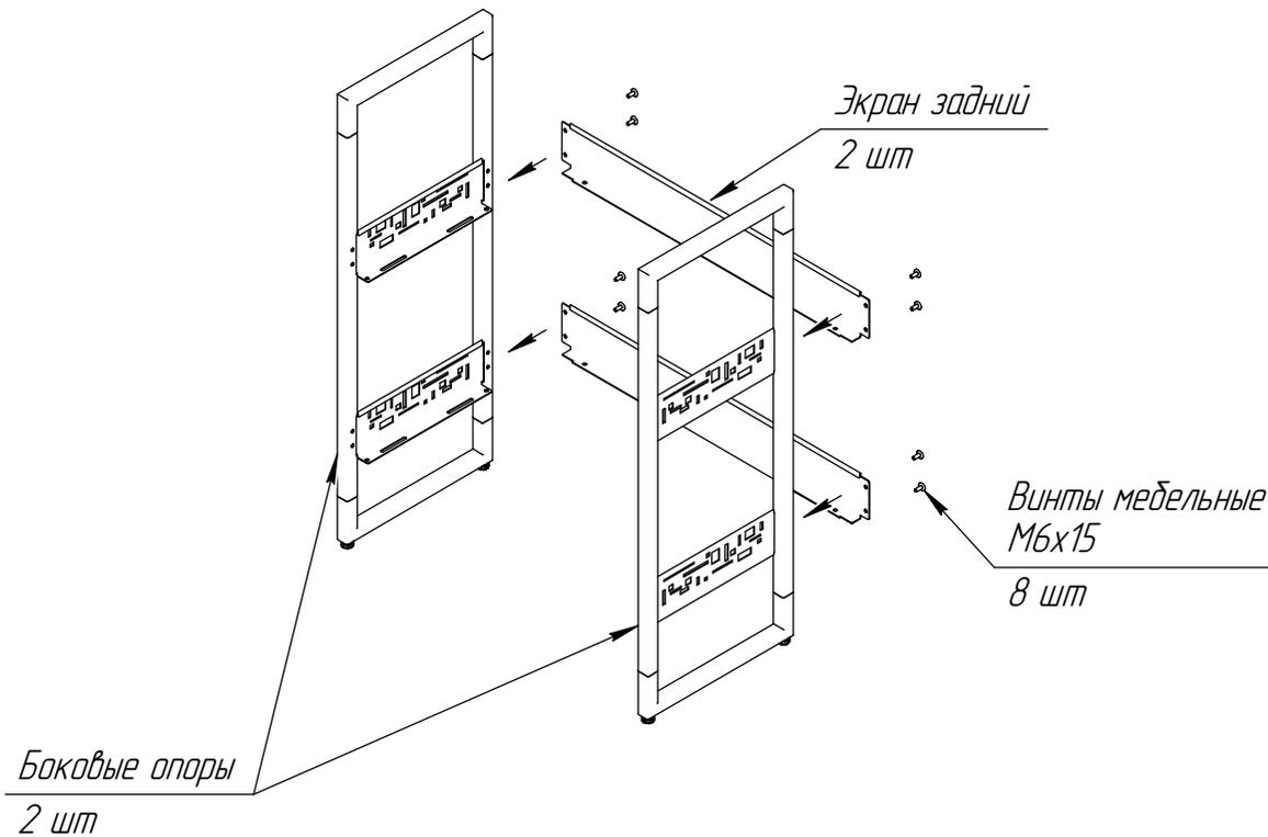
*Схема сборки - Установка полок на металлокаркас стеллажа*
